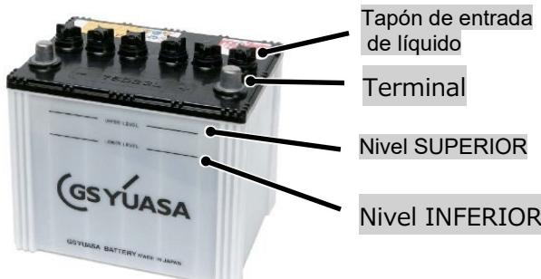
Compruebe el nivel de electrolito durante la inspección de puesta en marcha diaria. Incluso cuando no esté en uso, compruebe el nivel de electrolito una vez al mes. Si el nivel de líquido ha descendido a menos de la mitad del nivel entre UPPER (nivel de líquido más alto) e LOWER (nivel de líquido más bajo), rellene con agua purificada (agua destilada) hasta el nivel UPPER.
